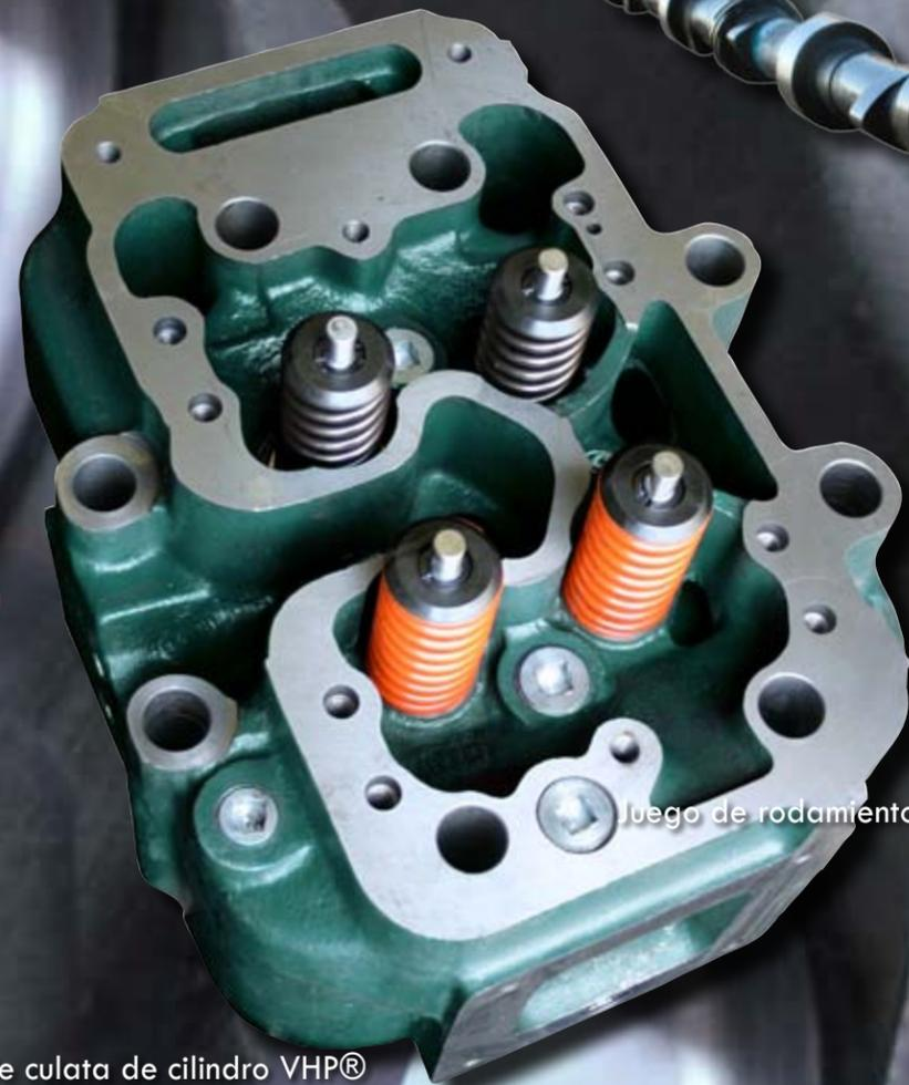
Montaje de culata de cilindro VHP®
