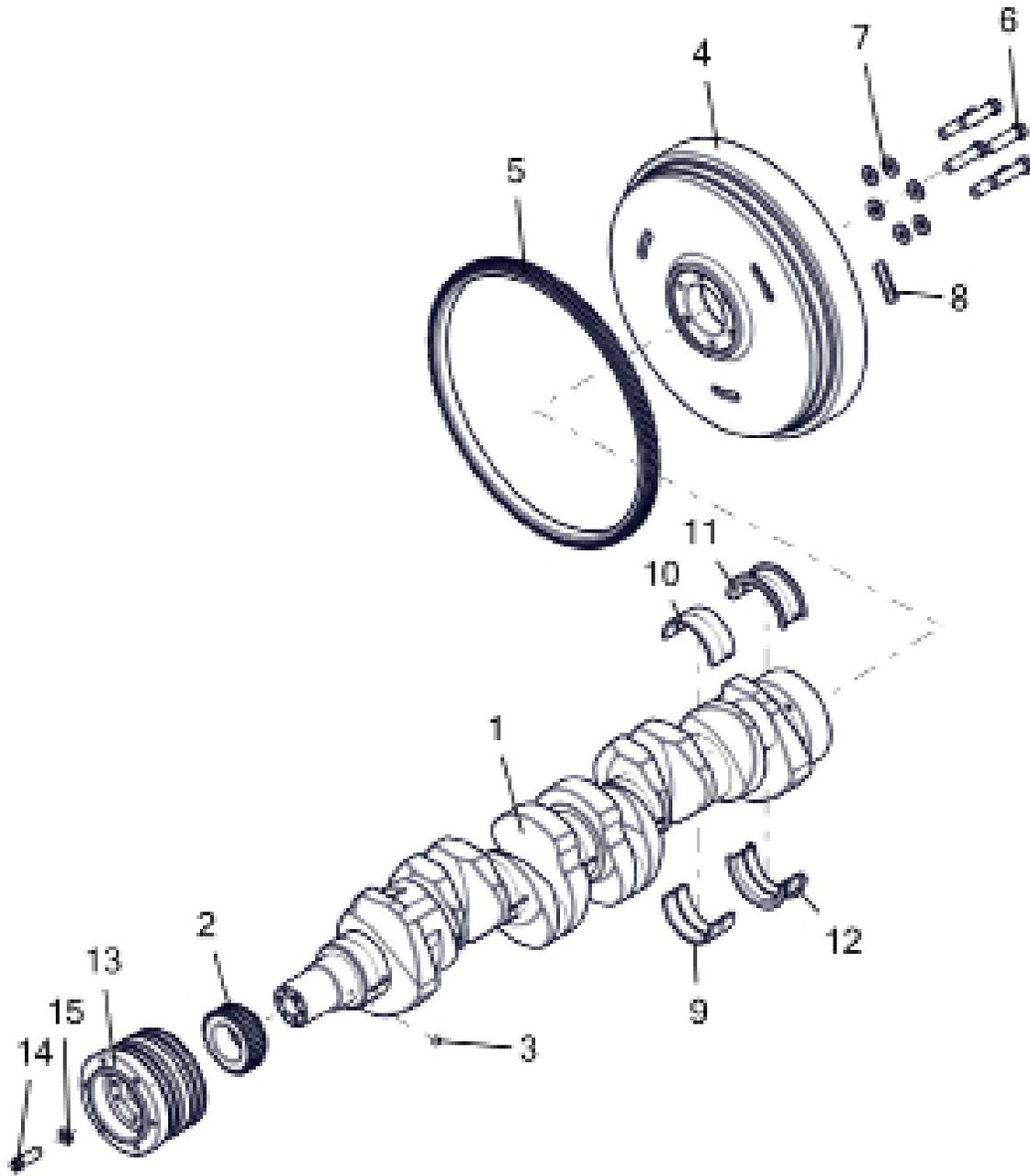
**CRANKSHAFT, PULLEY, FLYWHEEL**
