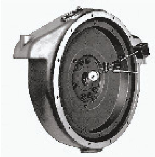
PILOT BEARING BORE RUNOUT
